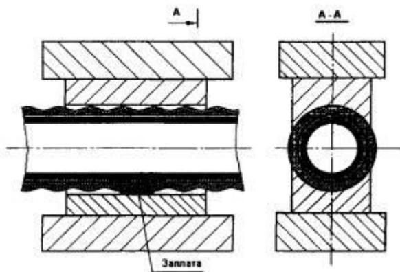
Рис. 6. Приспособление для ремонта посредством вулканизации
