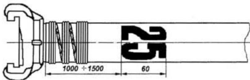
Рис. 4. Дополнительная маркировка рукава на рукавной базе
